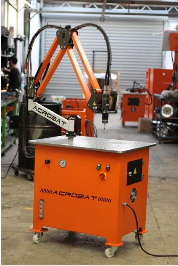
Huk 2000 Rh Hidrolik Kılavuz Çekme Makinası M5-M16 arası kılavuz çekme kapasitesine sahip modelimizdir. Yarıçapta 2050 mm'ye kadar açılabilen kol yapısı sayesinde siz kullanıcılara geniş çalışma alanı sağlamaktadır.
