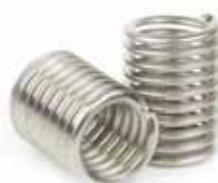
Paslanmaz çelikte gösterilen ipliklerdeki Inox vidalarının kullanımından kaynaklanan aşınmayı ortadan kaldırma için tasarlanmıştır. Bu malzemeden yapılan insertler, yüzey işlemlerine veya anti-kapsülü tortulara ihtiyaç duymaz, bu nedenle, "salgılama" olmadığı için, vakumlu işlerde kullanım için idealdirler, ayrıca, yüzey işleminin tabi olduğu sıcaklık sınırlamalarına da sahip değildirler, örn. kadmiyum veya kuru-yağlama maddesi.
